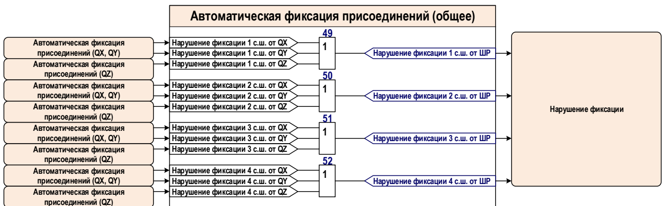
Рисунок 8.31 – Логическая схема автоматического формирования фиксации присоединений (общее) терминала БЭ2704 403
