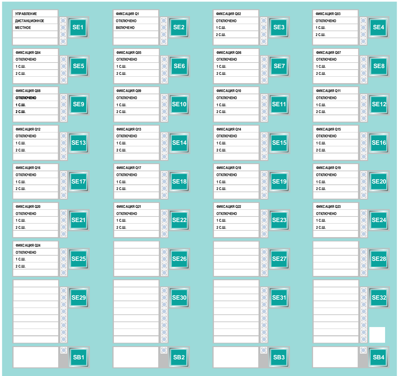
Рисунок 8.3 – Панель электронных ключей на двери шкафа ШЭ2607 065
