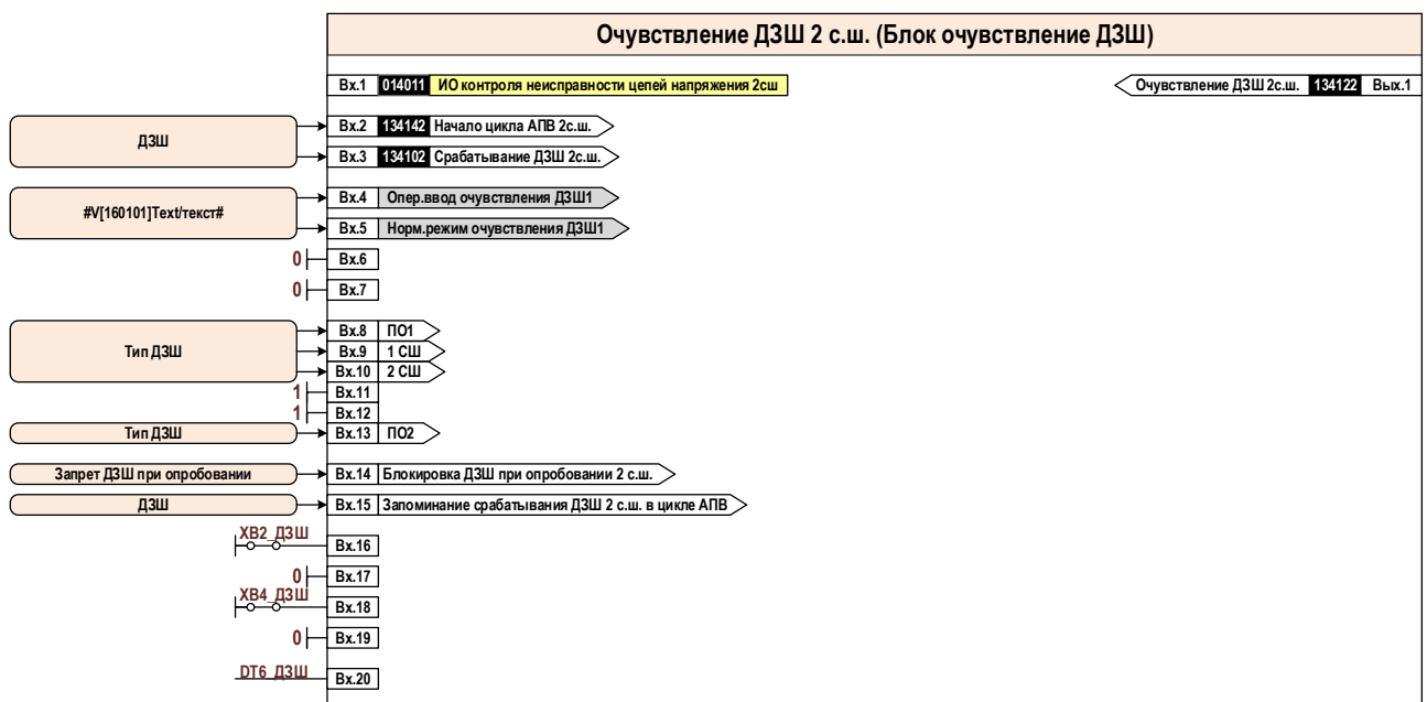
Рисунок 8.38 – Блок-схема логики очувствления 1 с.ш., 2 с.ш. терминала БЭ2704 403
